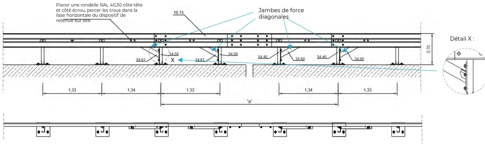
Monter chaque jambe de force diagonale avec 3 vis RAL 40.04 et écrous. Le sens de montage dépend de l'accessibilité. Utiliser une rondelle RAL 40.31 du côté opposé à la jambe de force et une rondelle RAL 40.30 du côté de la jambe de force. Les trous doivent être percés sur site dans le support.
