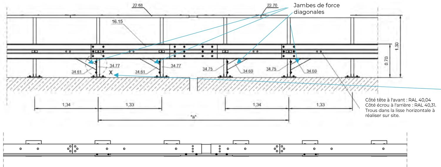
Monter chaque jambe de force diagonale avec 3 vis RAL 40.04 et écrous. Le sens de montage dépend de l'accessibilité. Utiliser une rondelle RAL 40.31 du côté opposé à la jambe de force et une rondelle RAL 40.30 du côté de la jambe de force. Les trous doivent être percés sur site dans le support.
