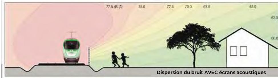
Les deux schémas comparent la propagation sonore **sans** (haut) et **avec** (bas) écrans acoustiques.
